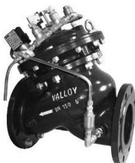
Válvula de controle unidirecional, operada por solenóide, instalada na linha de recalque próximo ao conjunto moto-bomba, permite a passagem do fluxo a partir da energização de uma solenóide após o acionamento do conjunto moto-bomba.
