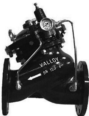
Válvula de controle auto-operada, unidirecional, instalada na rede, tem a função de reduzir uma pressão de entrada mais alta e variável em uma pressão mais baixa e constante de saída, independente das variações da vazão. É recomendado para tubulações com velocidade de fluxo entre 2 a 5 m/s
