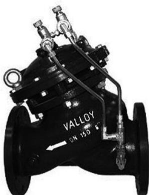
Válvula de controle auto-operada, unidirecional, instalada na linha de recalque próximo ao conjunto moto-bomba, tem a função de reter o fluxo reverso na ocasião da parada da bomba. Quando a pressão à jusante for maior que a pressão à montante da válvula, a válvula se fecha com velocidade regulável e controlada e vice-versa. É recomendada para tubulações com velocidade de fluxo entre 0,5 a 5 m/s.
