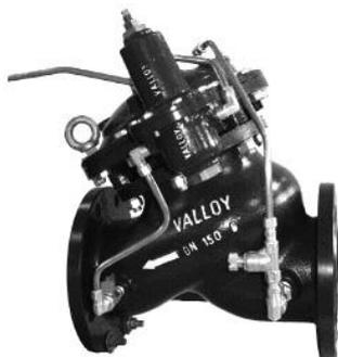
Válvula de controle auto-operada, unidirecional, instalada ao longo da rede, tem a função de limitar a vazão máxima através do Piloto Controlador de Vazão.
