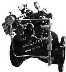
Válvula de controle auto-operada, unidirecional, instalada na linha de recalque próximo ao conjunto moto-bomba, controla a pressão de saída da bomba e retém o fluxo reverso quando a bomba estiver desligada. É recomendado para tubulações com velocidade de fluxo entre 0,5 a 5 m/s.
