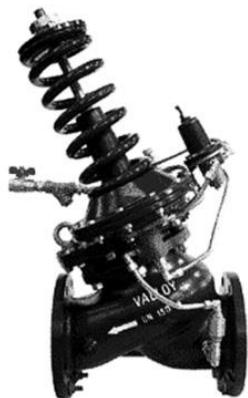
Válvula de controle auto-operada, unidirecional, instalada na entrada de reservatórios, tem a função de controlar seus níveis máximo e mínimo, por intermédio de um sinal de controle do nível do reservatório.
