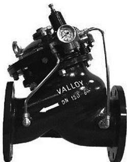
Válvula de controle auto-operada, unidirecional, pode ser instalada em derivação ou em linha, dependendo da função desejada. Tem a função principal de manter uma pressão constante na rede à sua montante.
