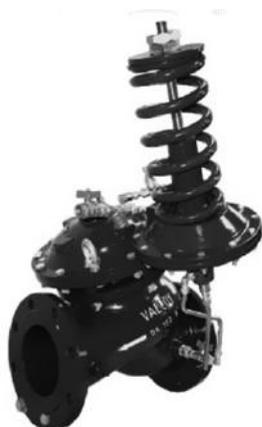
Tem a função de controlar os níveis máximo e mínimo por intermédio de uma tomada de pressão do reservatório. Abre e fecha automaticamente com velocidade controlada.
