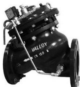
Válvula de controle operada por solenóide, unidirecional, pode ser instalada na rede como também em derivação, tem a função de abrir e fechar por intermédio de um comando elétrico, sendo recomendado para utilização em tubulações com velocidade de fluxo entre 0,5 a 5 m/s.
