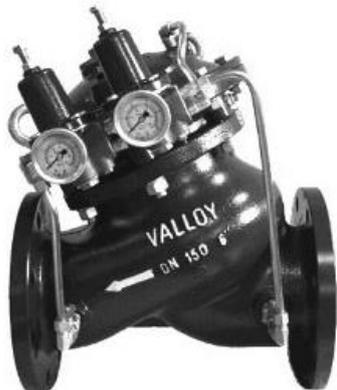
Válvula de controle auto-operada, unidirecional, pode ser instalada em linha, tem a função principal de manter uma pressão constante na rede à sua montante e, reduzir a pressão de entrada para uma pressão mais baixa e constante de saída.
