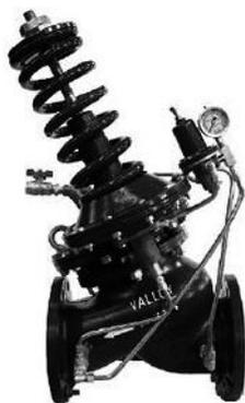
Válvula de controle auto-operada, unidirecional, instalada na entrada de reservatórios, tem a função de controlar seus níveis máximo e mínimo e reduzir altas pressões de entrada para pressões mais baixas e constantes na saída.
