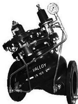
Válvula de controle auto-operada, unidirecional, instalada ao longo da rede, tem a função de limitar a vazão máxima através do Piloto Controlador de Vazão, sendo recomendada para tubulações com velocidade de fluxo entre 1 a 5 m/s.
