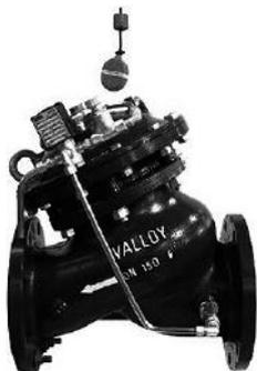
Válvula de controle operada por solenóide, unidirecional pode ser instalada na rede como também em derivação, tem a função de abrir e fechar por intermédio de um comando elétrico, sendo recomendado para utilização em tubulações com velocidade de fluxo entre 0,5 a 5m/s. A tensão elétrica utilizada pode ser corrente alternada ou contínua, tendo as opções de fazer a válvula abrir ou fechar com a falta de energia.
