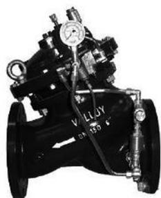
Válvula de controle auto-operada, unidirecional, instalada na linha de recalque próximo ao conjunto moto-bomba, controla a pressão de saída da bomba e retém o fluxo reverso quando a bomba estiver desligada. É recomendado para tubulações com velocidade de fluxo entre 0,5 a 5 m/s.
