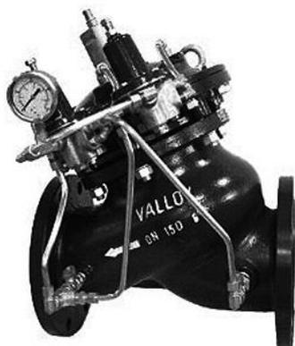
Válvula de controle auto-operada, unidirecional, instalada em derivação da linha a ser controlada, tem a função de proteger a rede contra ondas de pressão ou transientes hidráulicos provenientes do desligamento do conjunto moto-bomba. Pode ser utilizado para velocidades de fluxo máximo de 15 m/s.
