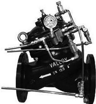
Válvula de controle auto-operada, unidirecional, instalada na entrada de reservatórios, tem a função de controlar seus níveis máximo e mínimo e, sustentar a pressão da rede a montante da válvula principal.
