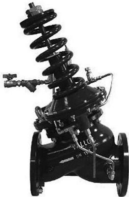
Válvula de controle auto-operada, bidirecional, instalada na entrada de reservatórios, tem a função de controlar seus níveis máximo e mínimo, e inverter o fluxo quando a pressão da coluna de água do reservatório for maior que a pressão da rede de alimentação.
